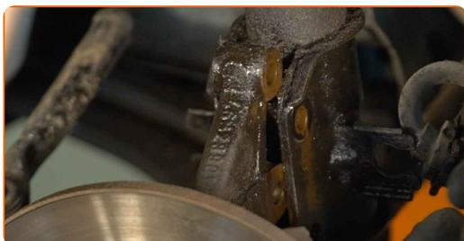
**18** Desapertar a fixação superior de montagem do suporte do amortecedor. Use uma chave soquete nº 19.
