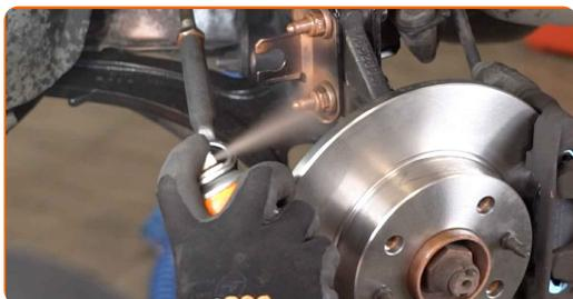
**47** Trate a superfície onde o disco de travão entra em contacto com o aro da roda. Use massa de cobre.
