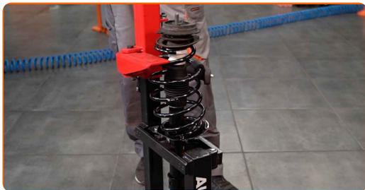
**35** Retire a coluna de suspensão montada.
