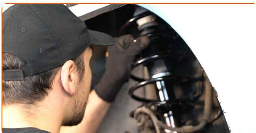
**37** Aparafuse a fixação superior de montagem do suporte do amortecedor. Não o aperte.
