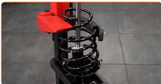
**31** Instale a manga para poeiras e a bomba de bloqueio no novo amortecedor.
