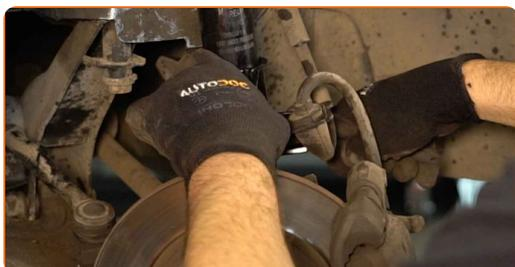
**46** Trate os fixadores do amortecedor. Use massa de cobre.
