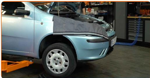
**8** Desaperte os parafusos da roda.
