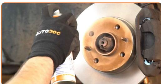
**48** Limpe a superfície do disco de travão. Utilize um produto de limpeza para travões. Substituição: kit de suspensão – Fiat Punto 188. Os especialistas da AUTODOC recomendam: Após aplicar o spray, espere alguns minutos.
