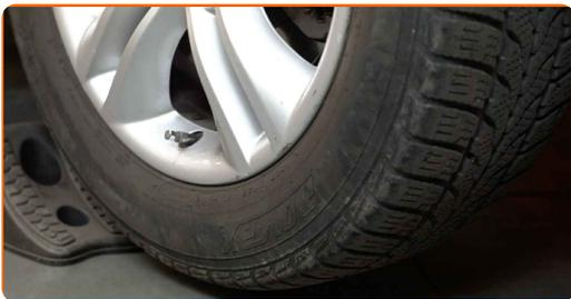
**5** Desaperte os parafusos da roda.
