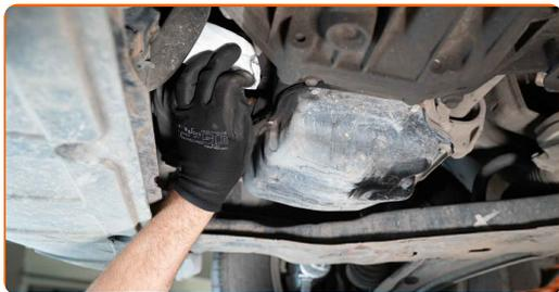
16 Limpe a área do orifício de drenagem do cárter.
