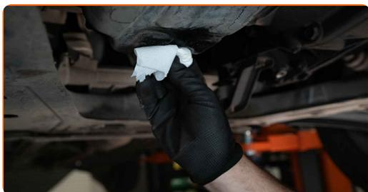
17 Aparafuse o novo bujão de drenagem e aperte-o. Use uma chave de torque. Aperte-o para o torque de 34 Nm.
