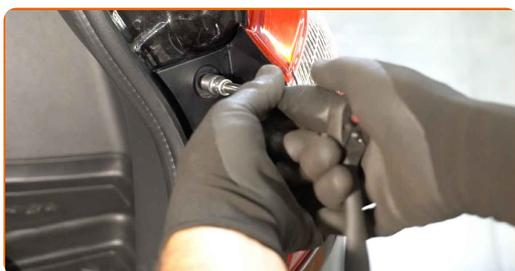
**9** Aperte o fixador que liga a luz traseira à carroçaria do veículo. Use uma chave soquete nº 10. Use uma chave de torque. Aperte-o para o torque de 13 Nm.
