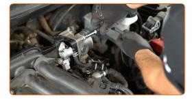
Solte o grampo e desconecte o conector e a mangueira de vácuo do coletor de admissão próximo à válvula do acelerador. Use alicates de ponta arredondada.
