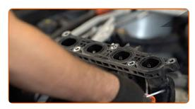
Remova a junta do coletor de admissão. Use uma chave de fenda plana.
