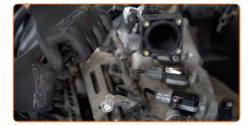
Aperte os fixadores do coletor de admissão. Use uma chave soquete nº 10. Use uma chave de torque. Aperte-o para o torque de 27 Nm.
