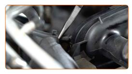
Desaparafuse os fixadores do coletor de admissão. Use uma chave soquete nº 10. Use uma chave de catraca.
