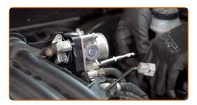
Ligue o conector e a mangueira de vácuo ao coletor de admissão próximo da válvula do acelerador. Use alicates de ponta arredondada.
