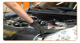
Desconecte a mangueira de ventilação do cárter do tubo de ventilação. Use alicates de ponta arredondada.
