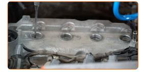
Desaperte as velas de ignição. Use o soquete da vela de ignição #16. Use uma chave de catraca.
