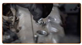
Aparafuse as novas velas de ignição e aperte-as. Use o soquete da vela de ignição #16. Use uma chave de torque. Aperte-o para o torque de 19.6 Nm.
