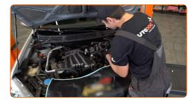
Desaparafuse os fixadores que conectam a válvula do acelerador ao coletor de admissão. Use uma chave soquete nº 8. Use uma chave de catraca.
