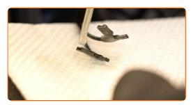
Retire os clipes da tampa do espelho retrovisor lateral do seu lugar. Utilize uma ferramenta de acabamento de plástico (2 peças).
