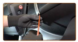
Desaparafuse os fixadores do puxador da porta. Use uma chave soquete nº 10. Use uma chave de catraca.
