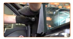
Fixe o conector do vidro elétrico ao módulo do interruptor.
