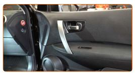
Desmonte o painel de acabamento do puxador da porta. Utilize uma ferramenta de acabamento de plástico.
