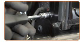
Trate o conector do interruptor do espelho elétrico. Use graxa dielétrica.
