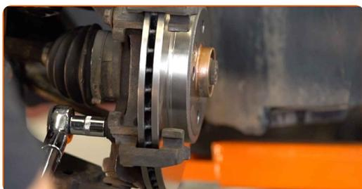
**23** Instale a pinça do travão e fixe-o. Use HEX n.º H7. Use uma chave de torque. Aperte-o para o torque de 30 Nm.
