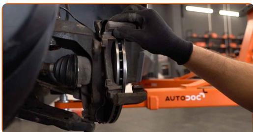
**22** Aperte a braçadeira da pinça do travão. Use uma chave soquete nº 16. Use uma chave de torque. Aperte-o para o torque de 110 Nm.
