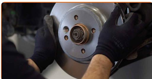
**19** Aperte a fixação do disco de travão. Use Torx T30. Use uma chave de torque. Aperte-o para o torque de 9 Nm.
