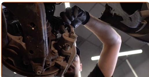
11 Desaparafuse a fixação de pinça de travão. Use HEX n.º H7. Use uma chave de catraca.
