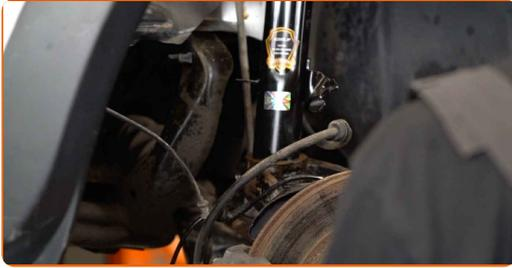
32 Instale e aperte um parafuso novo à manga do eixo. Use XZN #14. Use uma chave de torque. Aperte-o para o torque de 81 Nm.
