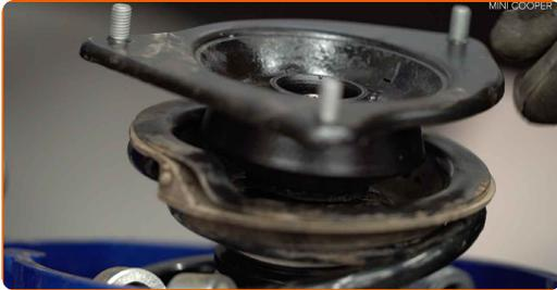
25 Aperte a porca do suporte do amortecedor da haste do pistão. Use uma chave soquete nº 18. Use uma chave combinada nº 18. Use HEX n.º H7 Use uma chave de torque. Aperte-o para o torque de 64 Nm.
