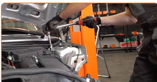
**40** Trate a haste da coluna do amortecedor. Use massa de cobre.
