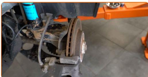
6 Limpe os fixadores da montagem superior do suporte do amortecedor. Use spray WD-40.
