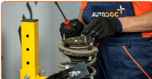
**24** Trate a haste da coluna do amortecedor. Use uma escova metálica. Use spray WD-40.
