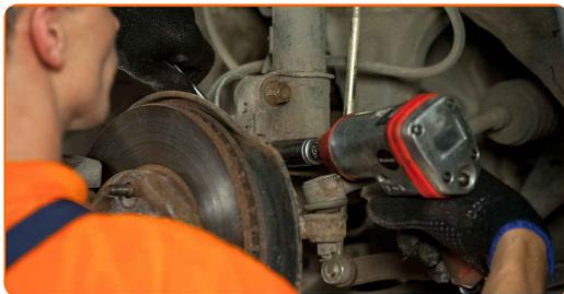
**45** Fixe a mangueira de travão na barra de suporte. Conecte a fixação do cabo do sensor ABS ao suporte do amortecedor. Use uma chave soquete nº 12. Use uma chave de catraca.
