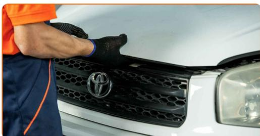
**16** Use uma cobertura de proteção para prevenir a danificação da pintura e das peças plásticas do automóvel.
