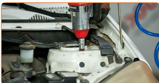
**37** Trate os fixadores do apoio da coluna de suspensão. Use massa de cobre.
