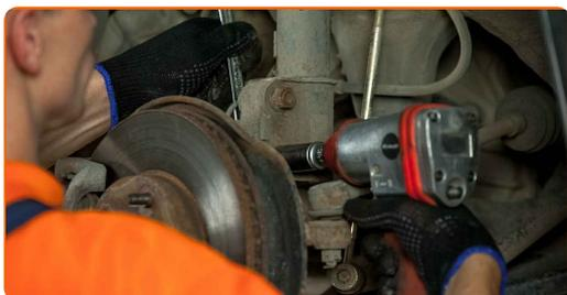
**49** Trate os fixadores do amortecedor. Use massa de cobre.
