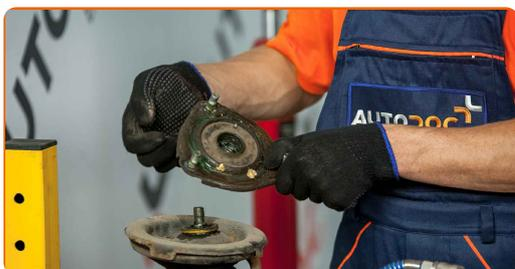
**27** Trate os fixadores do apoio da coluna de suspensão. Use spray WD-40.
