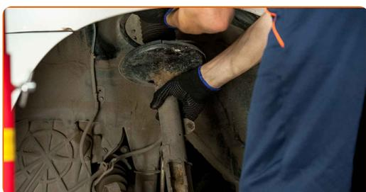
**35** Aparafuse a fixação superior de montagem do suporte do amortecedor.
