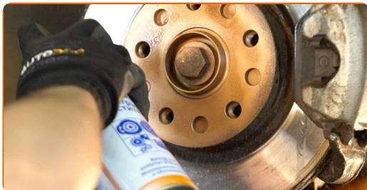
**51** Limpe a superfície do disco de travão. Utilize um produto de limpeza para travões.
