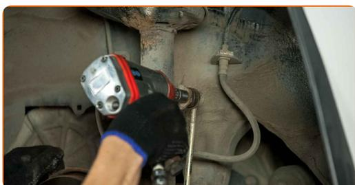
**48** Aperte os fixadores inferiores que conectam a coluna de suspensão à manga de eixo. Use uma chave combinada nº 19. Use uma chave soquete nº 19. Use uma chave de torque. Aperte-o para o torque de 143 Nm.
