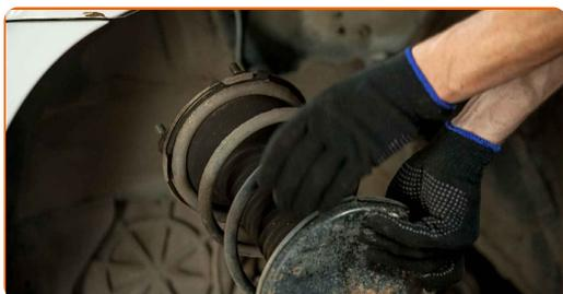
**21** Coloque o suporte do amortecedor sobre a ferramenta de compressão da mola.
