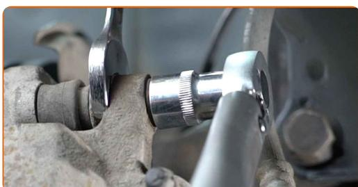
**32** Aperte os parafusos do suporte da pinça do travão. Use uma chave soquete nº 17. Use uma chave de torque. Aperte-o para o torque de 106 Nm.
