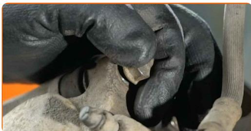
**31** Aperte os fixadores da pinça do travão. Use uma chave combinada nº 17. Use uma chave soquete nº 14. Use uma chave de torque. Aperte-o para o torque de 26 Nm.
