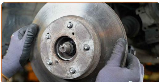
**18** Limpe o cubo. Use uma escova metálica. Use o spray de limpeza universal.
