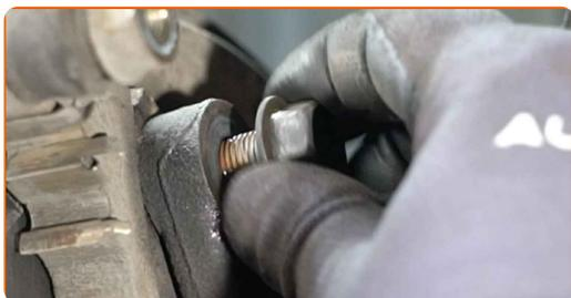
**24** Aparafuse os fixadores do suporte da pinça de travão. Use uma chave soquete nº 17. Use uma chave de catraca.
