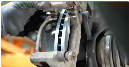
**23** Instale os parafusos de fixação.
