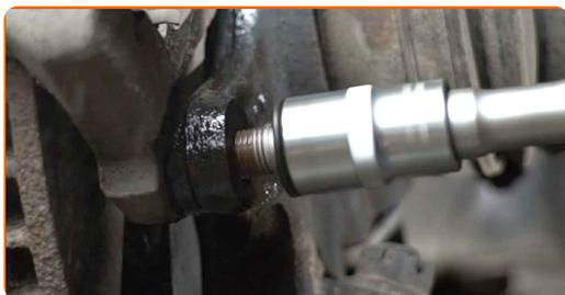
**15** Retire os parafusos de fixação.
