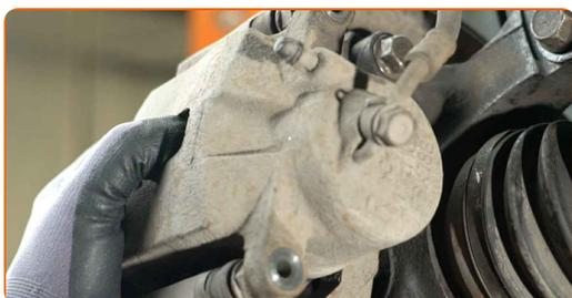
**30** Instale os parafusos de fixação.
