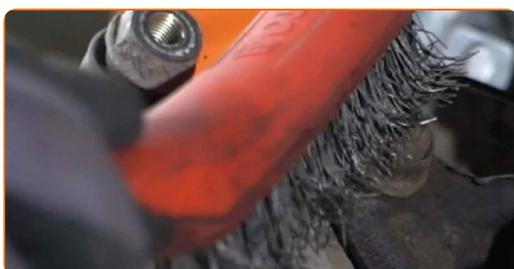
**14** Desaperte os parafusos do suporte da pinça do travão. Use uma chave soquete nº 17. Use uma chave de catraca.
