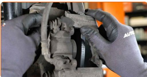
**18** Aperte os fixadores da pinça do travão. Use uma chave soquete nº 14. Use uma chave de torque. Aperte-o para o torque de 44 Nm.
