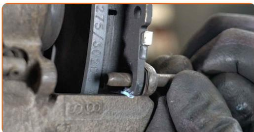
**25** Instale as molas de retenção das pastilhas de travão. Use uma chave de fenda plana.
