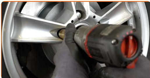
**32** Baixe o carro e trabalhar em ordem transversal, apertar os parafusos das rodas. Use o soquete de impacto para roda #19. Use uma chave de torque. Aperte-o para o torque de 103 Nm.
