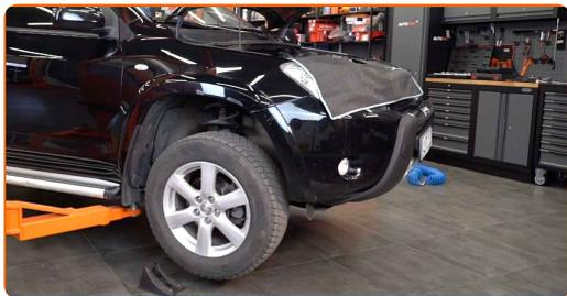
**8** Desaperte os parafusos da roda.
