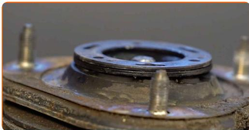
**23** Trate a haste da coluna do amortecedor. Use uma escova metálica. Use spray WD-40.
