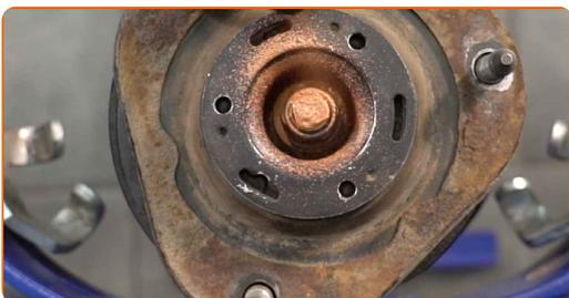
**36** Instale a tampa do apoio da coluna de suspensão.
