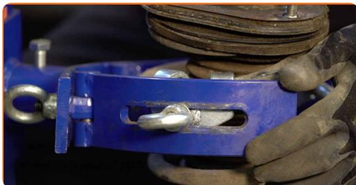
**22** Remova a tampa do apoio da coluna de suspensão.
