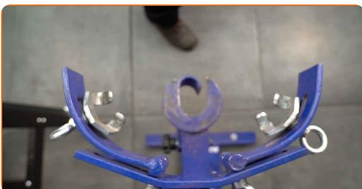
**38** Limpe os assentos de montagem da coluna do amortecedor. Use uma escova metálica. Use spray WD-40.
