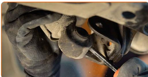
**18** Limpe o elemento de fixação do suporte do sensor ABS. Use spray WD-40.
