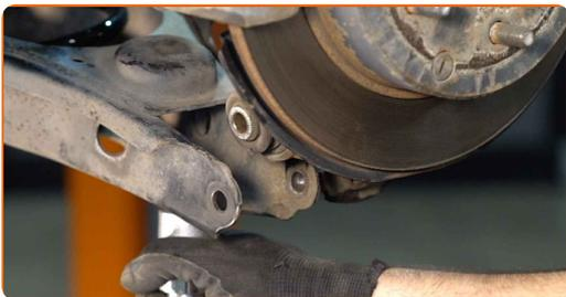
**33** Limpe os locais de montagem e a rosca do braço da suspensão. Use uma escova metálica. Use spray WD-40.
