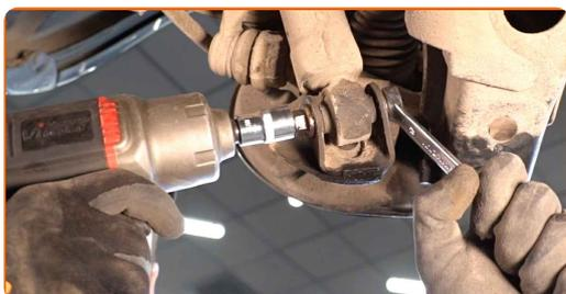
**16** Puxe para baixo o braço da suspensão. Remova o parafuso de fixação.
