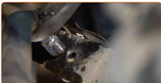
**20** Limpe os elementos de fixação do amortecedor. Use uma escova metálica. Use spray WD-40.
