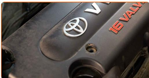
**21** Aperte os fixadores da tampa do motor. Use uma chave soquete nº 10. Use uma chave de catraca.
