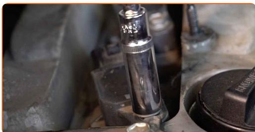
**7** Retire os parafusos de fixação.
