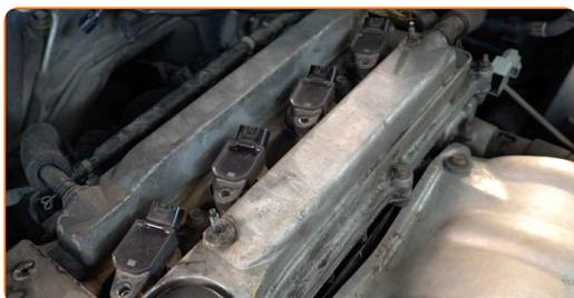
**8** Retire a bobina de ignição do orifício da vela de ignição.
