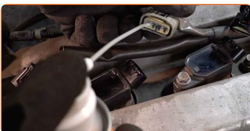
**19** Ligue os conectores das bobinas de ignição. Certifique-se que ouve um clique a indicar que está fixa no local.
