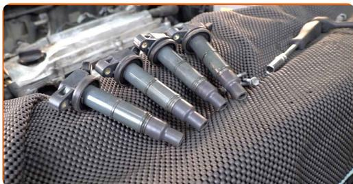
**Substituição: vela de ignição – Toyota RAV4 III. Conselho:**
