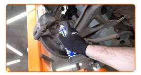
Desaperte a fixação da braçadeira da pinça. Use uma chave soquete nº 18. Use uma chave de catraca. Use uma chave de tarraxa.
