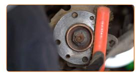
Instale o novo disco de travão no cubo e aperte os parafusos.
