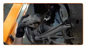
Aperte a braçadeira da pinça do travão. Use uma chave soquete nº 18. Use uma chave de torque. Aperte-o para o torque de 100 Nm.
