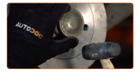
Trate da superfície onde a jante da roda entra em contacto com o tambor de travão. Use massa de cobre.
