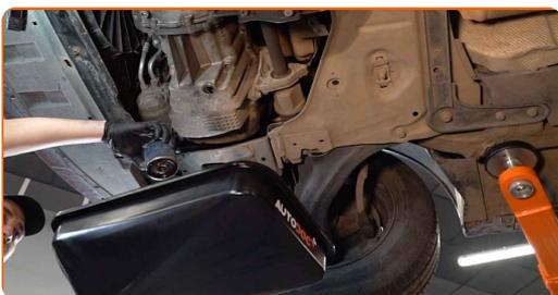
Substituição: óleo do motor e filtro – RENAULT 21 Van. Conselho da AUTODOC:
