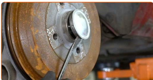
**7** Desaparafuse o fixador do cubo de roda. Use uma chave soquete nº 30. Use uma chave de tarraxa.
