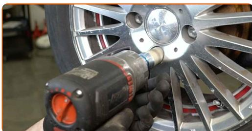
**24** Baixar o carro e trabalhar em ordem transversal, apertar os parafusos das rodas. Use o soquete de impacto para roda #17. Use uma chave de torque. Aperte-o para o torque de 110 Nm.
