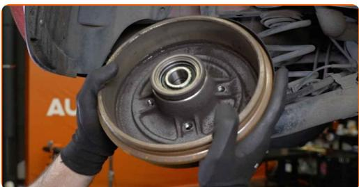
**Substituição: rolamento da roda – RENAULT 5 Hatchback. Conselho:**
