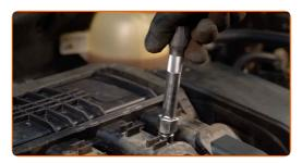
Aparafuse as novas velas de ignição e aperte-as. Use o soquete da vela de ignição #16. Use uma chave de torque. Aperte-o para o torque de 28 Nm.
