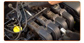
Aplique uma camada fina de um lubrificante antigripante de alta temperatura específico às roscas das novas velas de ignição.
