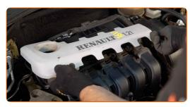
Remova os conectores de fio da vela de ignição dos poços da vela de ignição. Use alicates de ponta arredondada.
