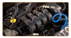
Desaperte as velas de ignição. Use o soquete da vela de ignição #16.
