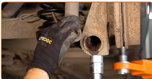
**15** Desaperte a fixação superior do amortecedor. Use uma chave soquete nº 17.
