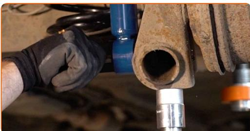
**23** Aparafuse o fixador inferior do amortecedor. Use uma chave soquete nº 18.
