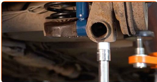
**25** Aperte a fixação inferior do amortecedor. Use uma chave soquete nº 18. Use uma chave de torque. Aperte-o para o torque de 105 Nm.
