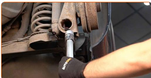
**12** Desaperte a fixação inferior do amortecedor. Use uma chave soquete nº 18. Use uma chave de tarraxa.
