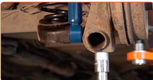
**22** Instale o parafuso de fixação.
