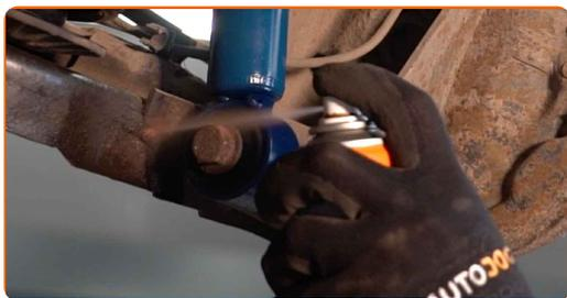
**28** Trate da superfície onde a jante da roda entra em contacto com o tambor de travão. Use massa de cobre.
