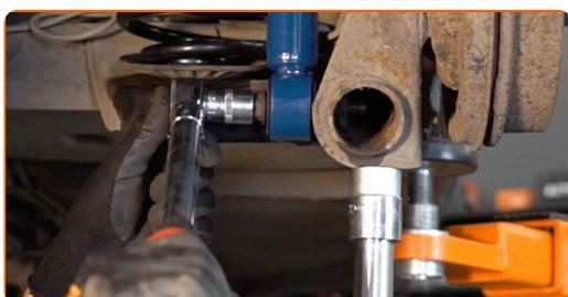
**26** Remova o apoio sob a viga do eixo traseiro.
