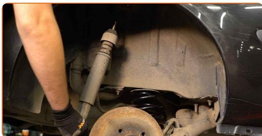
**17** Remova o suporte do amortecedor, a coifa e o batente de encosto do amortecedor.
