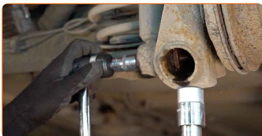
**13** Remova o parafuso de fixação.
