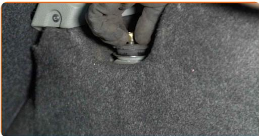
**21** Conecte a parte inferior do amortecedor.
