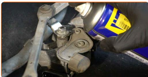
**16** Desaparafuse os fixadores do motor do limpapa-brisas. Use uma chave combinada nº 13.
