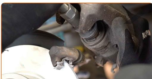
Substituição: pastilhas de travão – RENAULT Clio III Hatchback (BR0/1, CR0/1). Conselho da AUTODOC:
