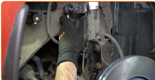
**12** Desaparafuse o fixador que conecta bieleta da barra estabilizadora à barra estabilizadora. Use uma chave soquete nº 17. Use uma chave de torque. Aperte-o para o torque de 44 Nm.
