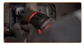
Desligue a instalação elétrica e a mangueira do travão do braço de suporte do amortecedor. Utilize um pé-decabra.
