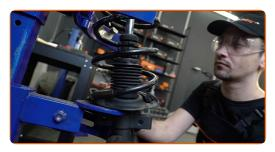
Instale o amortecedor no arco da roda.
