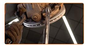
Aperte os fixadores inferiores que conectam a coluna de suspensão à manga de eixo. Use uma chave soquete nº 18. Use uma chave de torque. Aperte-o para o torque de 105 Nm.
