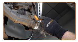
Desaperte a fixação da articulação esférica da manga de eixo. Use uma chave soquete nº 17. Use uma chave de catraca.
