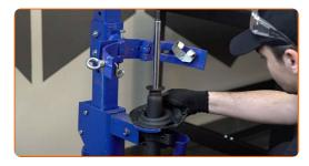
Instale a manga para poeiras e a bomba de bloqueio no novo amortecedor.
