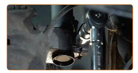
Conecte a fixação do cabo do sensor ABS ao suporte do amortecedor. Fixe a mangueira de travão na barra de suporte.
