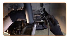
61 Instale o terminal do estabilizador transversal.
