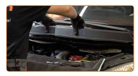
Desaparafuse o fixador da grelha do para-brisas localizado no lado direito. Use Torx T20.
