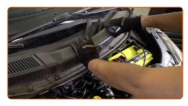
Aparafuse a grelha do para-brisas localizada no lado esquerdo. Use uma chave soquete nº 10.
