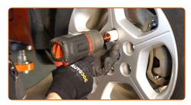
Baixar o carro e trabalhar em ordem transversal, apertar os parafusos das rodas. Use uma chave de torque. Aperte-o para o torque de 108 Nm.
