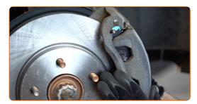
Aperte a braçadeira da pinça do travão. Use uma chave soquete nº 19. Use uma chave de torque. Aperte-o para o torque de 165 Nm.
