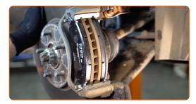
Instale a pinça do travão e fixe-o. Use uma chave combinada nº 17. Use uma chave soquete nº 14. Use uma chave de torque. Aperte-o para o torque de 26 Nm.
