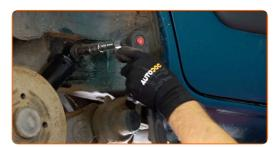
Aperte a fixação inferior do amortecedor. Use uma chave soquete nº 16. Use uma chave de torque. Aperte-o para o torque de 105 Nm.
