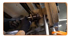
Desaperte a fixação superior do amortecedor. Use uma chave soquete nº 16. Use uma chave combinada nº 18. Use uma chave de tarraxa.
