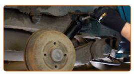
Apertar a fixação superior do amortecedor. Use uma chave soquete nº 16. Use uma chave combinada nº 18. Use uma chave de torque. Aperte-o para o torque de 105 Nm.
