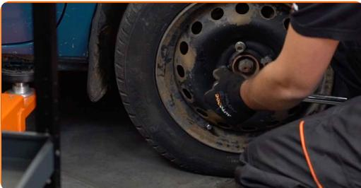
**39** Apertar o suporte superior do amortecedor. Use uma chave combinada n° 21. Use HEX n.º H6 Use uma chave de torque. Aperte-o para o torque de 62 Nm.
