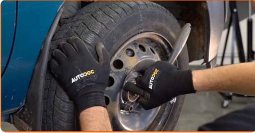
**38** Baixe o carro e trabalhar em ordem transversal, apertar os parafusos das rodas. Use o soquete de impacto para roda #19. Use uma chave de torque. Aperte-o para o torque de 110 Nm.
