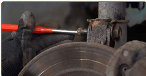
**14** Desaperte a fixação do suporte superior do braço do amortecedor. Use uma chave soquete n° 21.
