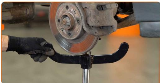
**13** Retire os parafusos de fixação (2 peças). Use um martelo. Use um saca-pino.
