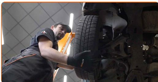
10 Limpe os elementos de fixação da coluna do amortecedor. Use uma escova metálica. Use spray WD-40.
