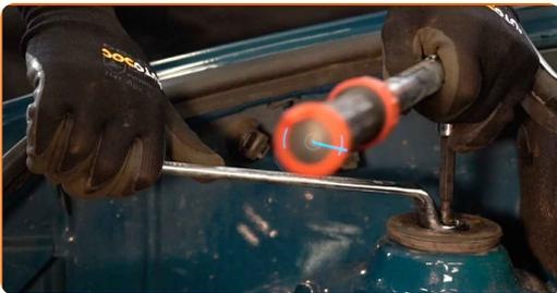
**40** Instale a tampa do apoio da coluna de suspensão.
