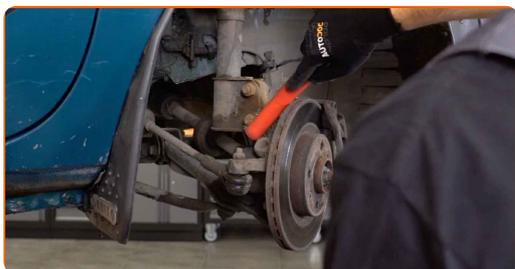
11 Desaparafuse o elemento de fixação inferior que liga a coluna de suspensão às mangas de eixo. Use uma chave soquete nº 21. Use uma chave combinada nº 21. Use uma chave de tarraxa.
