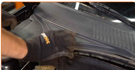
**14** Instale os fixadores da carenagem da grelha de plástico do limpa para-brisas.
