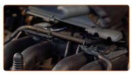
Remova os conectores de fio da vela de ignição dos poços da vela de ignição. Use alicates de ponta arredondada.
