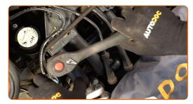
Retire as velas de ignição. Use o soquete da vela de ignição #16.
