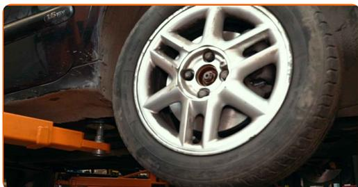
75 Aperte o parafuso que liga o eixo de transmissão ao cubo de roda. Use uma chave soquete nº 30. Use uma chave de torque. Aperte-o para o torque de 280 Nm.
