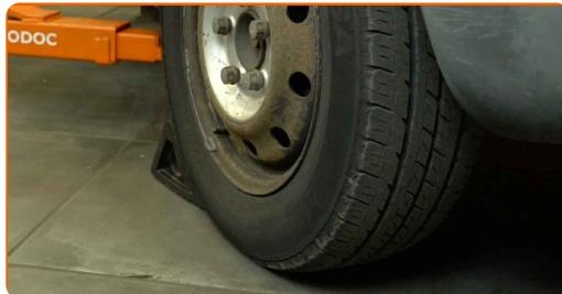
2 Desapertar os elementos de fixação da roda. Utilizar uma chave de impacto de 24 mm para rodas. Utilizar uma chave em T com barra deslizante.
