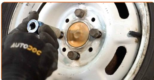
**23** Baixar o carro e trabalhar em ordem transversal, apertar os parafusos das rodas. Use uma chave de torque. Aperte-o para o torque de 90 Nm.
