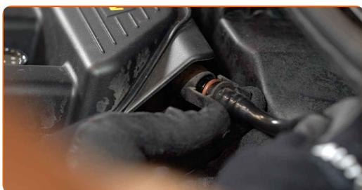
7 Desapertar os parafusos de fixação da caixa do filtro. Use Torx T25.
