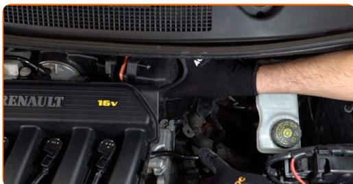
13 Apertar os parafusos de fixação da caixa do filtro. Use Torx T25.
