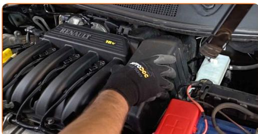
16 Aparafuse os fixadores da caixa do filtro de ar. Use uma chave soquete nº 10.
