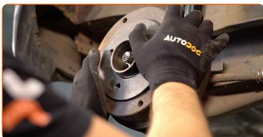
**18** Aperte o cubo. Use uma chave soquete nº 30. Use uma chave de torque. Aperte-o para o torque de 170 Nm.
