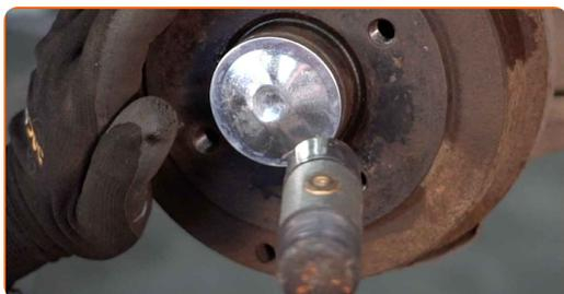
**20** Trate a superfície onde a jante da roda entra em contacto com o tambor de travão. Use massa de cobre.
