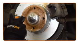
Limpe a superfície do disco de travão. Use uma escova metálica. Utilize um produto de limpeza para travões.
