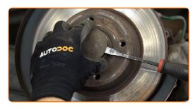
Desaperte a porca de fixação do cubo. Use uma chave soquete nº 30. Use uma chave de tarraxa.
