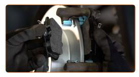
Instale a pinça do travão e fixe-o. Use uma chave combinada nº 15. Use uma chave soquete nº 13. Use uma chave de torque. Aperte-o para o torque de 35 Nm.
