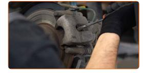
Limpe os elementos de fixação da pinça de travão. Use uma escova metálica. Use spray WD-40.
