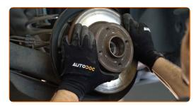
Instale o disco do travão instalado com o rolamento do cubo da roda.
