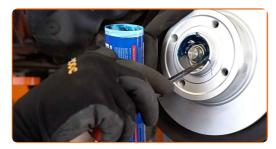
Instale a tampa da porca do cubo. Use um martelo de borracha.
