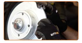
Aperte a braçadeira da pinça do travão. Use uma chave soquete nº E16. Use uma chave de torque. Aperte-o para o torque de 105 Nm.
