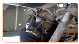
Desaperte a fixação da braçadeira da pinça. Use uma chave soquete nº E16. Use uma chave de tarraxa.
