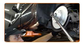
Trate o cubo onde entra em contacto com o disco de travão. Use um lubrificante multiusos.
