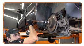
Remova o disco de travão instalado com o rolamento do cubo da roda.
