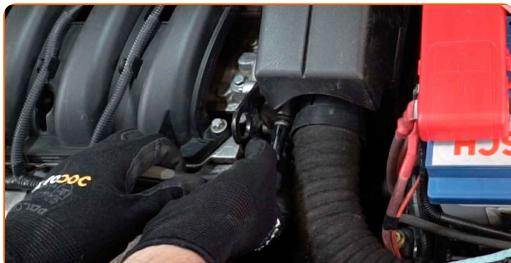
**4** Desconecte o tubo de entrada de ar da caixa do filtro de ar.
