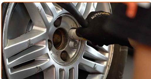
**22** Baixar o carro e trabalhar em ordem transversal, apertar os parafusos das rodas. Use uma chave de torque. Aperte-o para o torque de 110 Nm.
