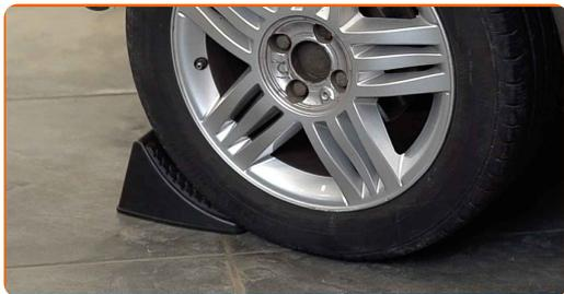
**5** Solte os parafusos de montagem das rodas. Use o soquete de impacto para roda #19.
