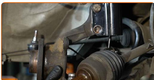
**53** Instale os parafusos de fixação.
