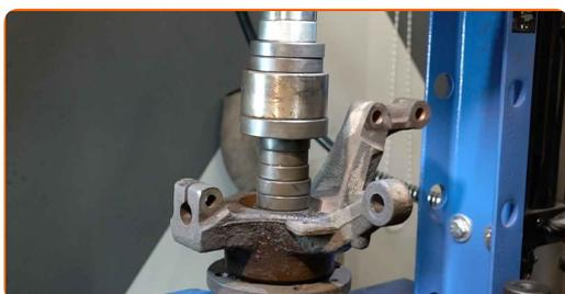
**50** Instale a manga de eixo com um cubo na montagem.
