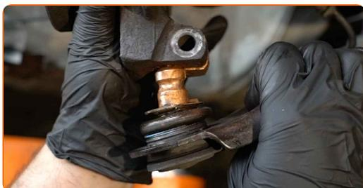
**57** Instale o parafuso de fixação.
