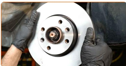
**67** Aperte a fixação do disco de travão. Use Torx T30. Use uma chave de torque. Aperte-o para o torque de 9 Nm.
