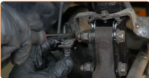
**9** Desaperte o suporte de fixação da mangueira do travão do amortecedor. Use uma chave soquete nº 10. Use uma chave de catraca.
