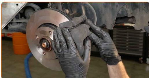
**69** Aperte a braçadeira da pinça do travão. Use uma chave soquete nº 18. Use uma chave de torque. Aperte-o para o torque de 105 Nm.
