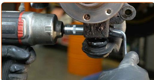
**23** Remova o parafuso de fixação.
