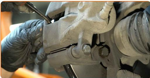
**12** Limpe os fixadores do suporte da pinça de travão. Use uma escova metálica. Use spray WD-40.
