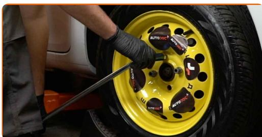
**3** Limpe os fixadores do eixo motor. Use spray WD-40.
