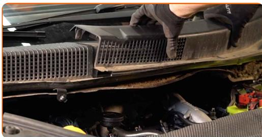
**6** Desaperte os parafusos de fixação da tampa de proteção. Use uma chave soquete n° 10. Use uma chave de catraca.
