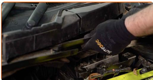
**17** Aperte os parafusos de fixação da tampa de proteção. Use uma chave soquete nº 10. Use uma chave de catraca.
