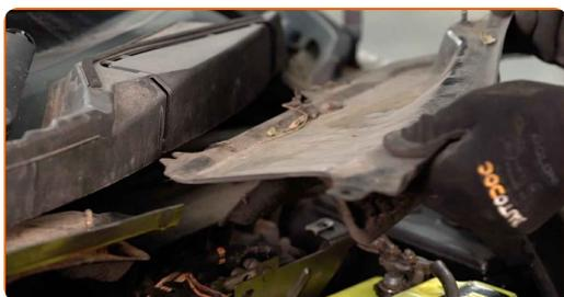
**8** Desapertar os parafusos de fixação da caixa do filtro. Use a chave Phillips.
