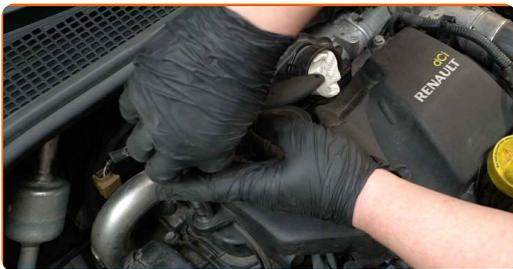
**20** Conecte a cablagem do motor. Use uma chave de fenda plana.
