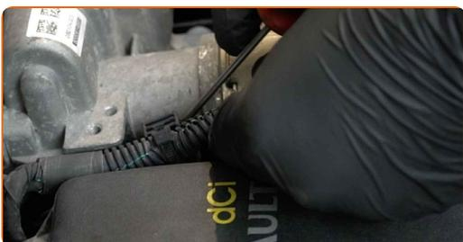
**8** Desaperte o fixador da tampa do motor. Use uma chave soquete nº 10. Use uma chave de catraca.
