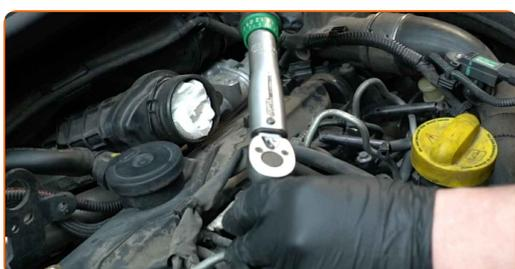
Substituição: velas incandescentes – RENAULT Megane IV Hatchback (B9A/M/N\_). Conselho da AUTODOC:
