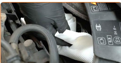
**7** Separe a cablagem do motor. Use uma chave de fenda plana.
