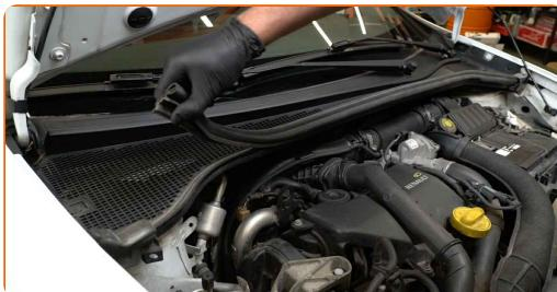
**4** Remova os clipe da grelha da capota. Use uma ferramenta de remoção de clipe.
