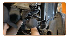
Apoie o eixo de torção da suspensão traseira. Use um macaco hidráulico de caixa de transmissão.
