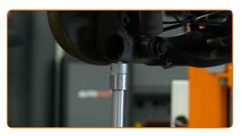
Desaperte a fixação inferior do amortecedor. Use uma chave soquete nº 18. Use uma chave de catraca.
