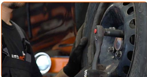
**32** Baixe o carro e trabalhe em ordem transversal, apertar os parafusos das rodas. Use uma chave de torque. Aperte-o para o torque de 110 Nm.
