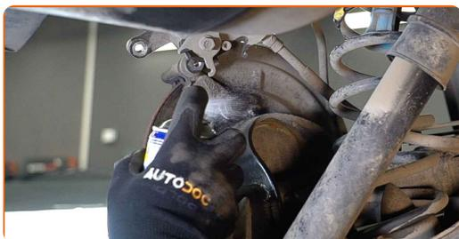
**13** Desaperte a fixação da braçadeira da pinça. Use uma chave soquete nº E16. Use uma chave de tarraxa.
