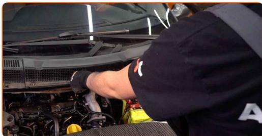
**19** Aparafuse a grelha do para-brisas localizada no lado esquerdo. Use uma chave soquete nº 10. Use uma chave de catraca.
