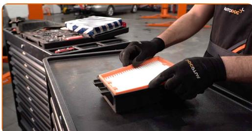
Substituição: filtro de ar – RENAULT Scénic III (JZ0/1\_). Conselho da AUTODOC:
