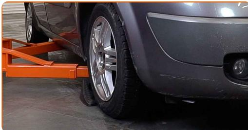
4 Solte os parafusos de montagem das rodas. Use o soquete de impacto para roda #19.
