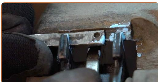
**14** Instale o pino de retenção da pastilha de travão. Use alicates de ponta arredondada.
