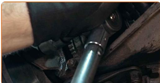
**24** Aperte os fixadores que ligam a junta esférica ao braço de suspensão. Use uma chave soquete nº 18. Use uma chave de torque. Aperte-o para o torque de 75 Nm.
