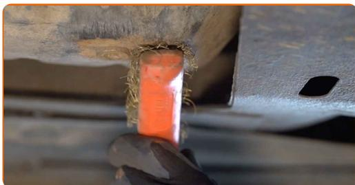
**7** Desaperte o bujão de drenagem. Use a chave quadrada do bujão de drenagem de óleo N.º8. Use uma chave de catraca.
