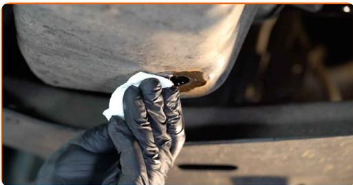
**16** Aparafuse o novo bujão de drenagem e aperte-o. Use a chave quadrada do bujão de drenagem de óleo N.º8. Use uma chave de torque. Aperte-o para o torque de 20 Nm.
