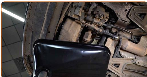
**6** Limpe a área do orifício de drenagem do cárter. Use uma escova metálica.
